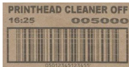
**Le ostruzioni degli ugelli e il deterioramento della codifica sono evidenti.**
